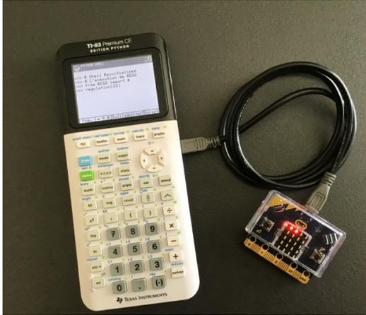
Le capteur de température utilisé est celui qui est intégré à la carte BBC microbit. On peut bien entendu utiliser une carte d'extension (shield) et connecter le capteur de température grove, puis le ventilateur.
